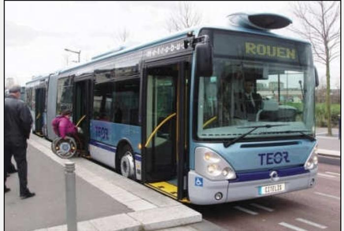
Les Irisbus Citelis du TEOR de Rouen sont équipés d'un système de guidage optique pour un accostage optimal autorisant un accès de plain-pied et l'autonomie. © ACTP
