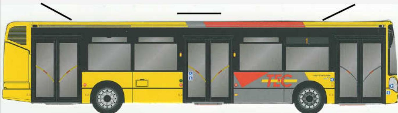
Positions des trappes de toiture et effets induits. Une trappe arrière en aspiration augmente l'efficacité des autres trappes placées en flux rasant ou en introduction.
